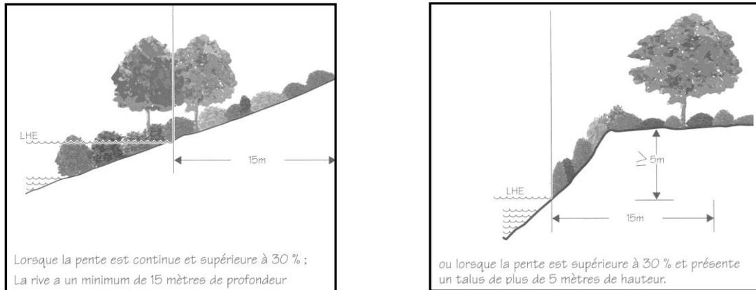
**Figure 10.2 : Rive de 15 mètres de profondeur**
