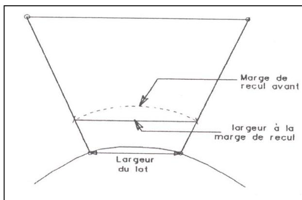
Figure 6.1 : Largeur minimale à la marge de recul
